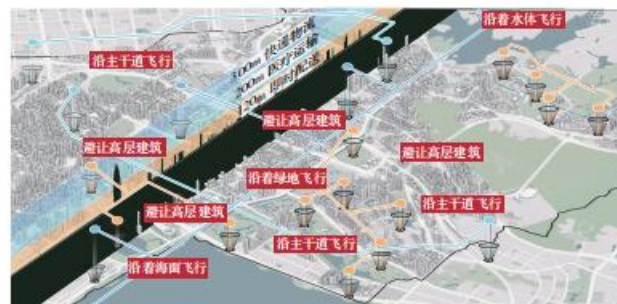
Fig. 5. Esquema de rutas de entrega con drones de baja altitud en entornos tridimensionales en el distrito de Nanshan, Shenzhen
