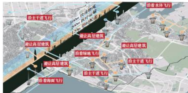
Fig.5 Schéma des itinéraires de livraison par drone à basse altitude dans des environnements 3D du district de Nanshan, à Shenzhen
