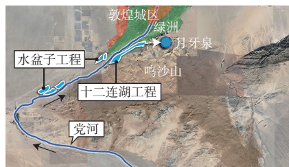
图5 党河上游生态补水工程示意
