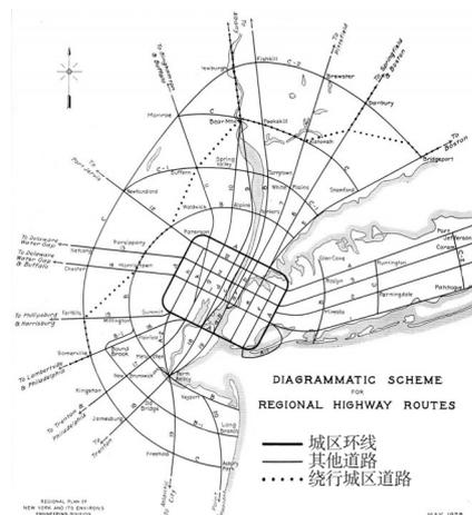
图6 纽约市区域高速公路网结构 (环状路+放射路) 示意图, 1928年
